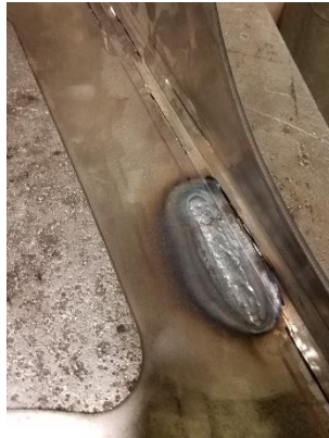
Tig Fill Welds
